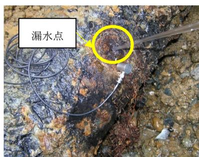
図-1 AE 法による漏水波検出
